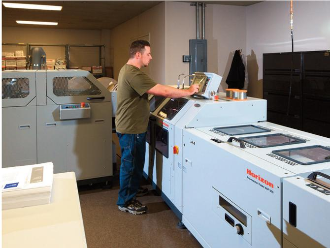
Abwickel- und Schneidetechnologie von Hunkeler sichert die hocheffiziente Inline-Produktion auf dem StitchLiner 6000 Digital bei Geschwindigkeiten von bis zu 6000 Booklets pro Stunde.
