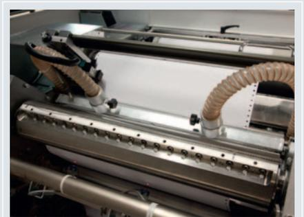
Für die Wirtschaftlichkeit und Wertschöpfung bildet in den Produktionslinien bei DVLA das Stanz- und Perforiermodul PP6 eine Schlüsselkomponente. Das Anbringen der Führungslochung und der Falzperforation (im Bild der Perforierzylinder) sind im gleichen Modul integriert. Der Inline-Prozess ermöglicht es DVLA, vormals extern auf vorkonfektionierte Rollen gedruckte vollfarbige Dokumente auf den zwei Hunkeler-Linien in Eigenregie zu produzieren.
