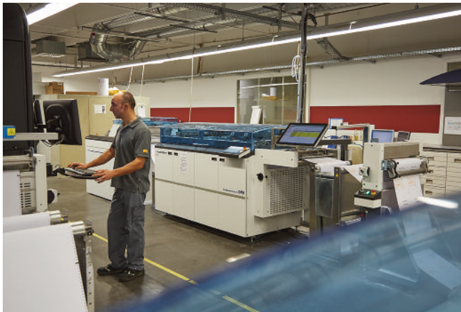
Das DP8-Modul ermöglicht das Fertigstellen von Dokumenten, von der weissen Papierbahn bis zum Endprodukt, mit variablen Inhalten und dynamisch wechselnden Stanz- und Perforationsmustern.
