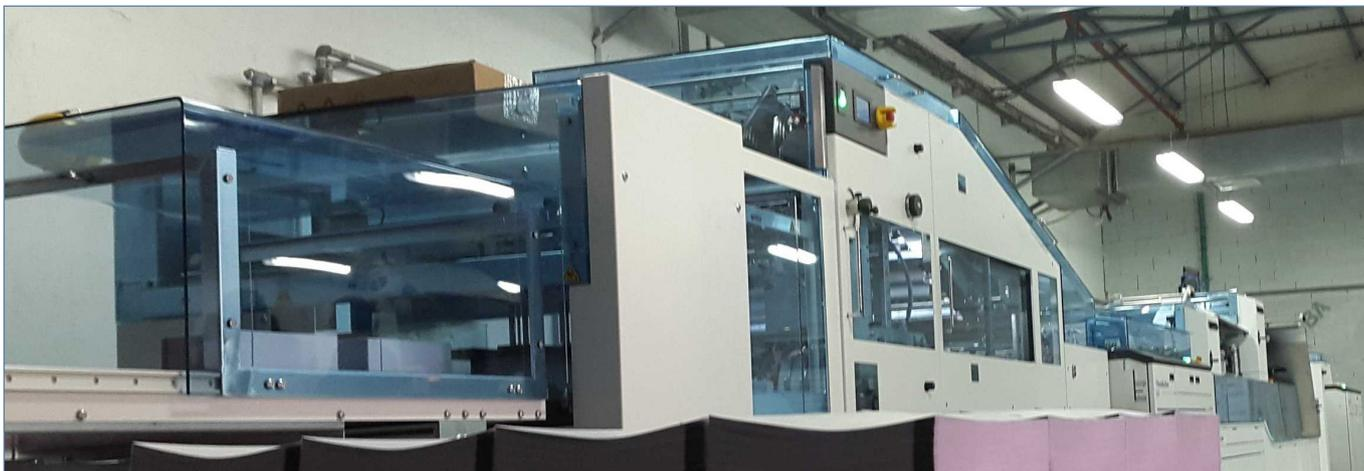
Die Produktionslinie ist vorerst als Nearline-System aufgestellt. Eine spätere Anbindung der Buchlinie an die Prosper 1000 von Kodak für die Inline-Produktion ist möglich.
