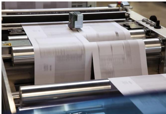
Eine Schlüsselkomponente in der POPP6-Linie ist der Webmerger WM6. Nach dem Längsschnitt werden die beiden Papierbahnen vor dem Eintritt in den CS6 registergenau übereinandergeführt.
