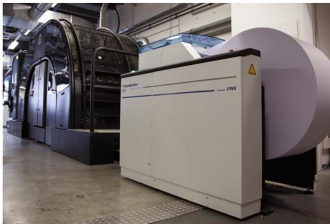
In Spitzenzeiten liefert die Hunkeler-Technologie der HP T200 Inkjet Web Press während 18 Stunden pro Tag Papier, bei Leistungen zwischen 61 und 122 Metern pro Minute.
