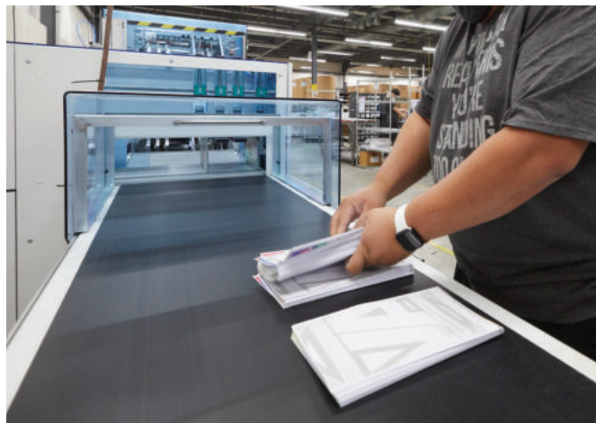
Einfaches sammeln der vorgeleimten Signaturbuchblöcke für die nachfolgende Klebebindung.
