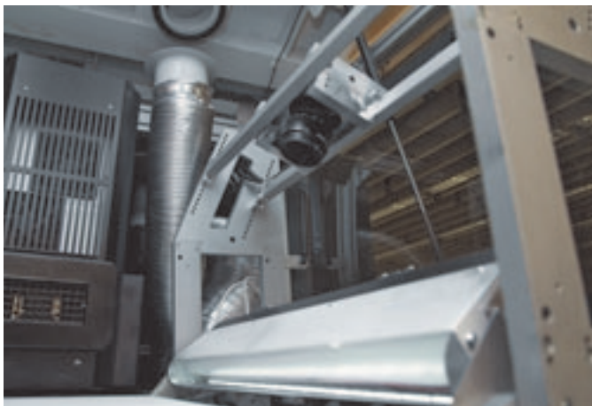
Zur Sicherstellung der Qualität sind die VL 2000 und die VL 6000 von Kodak mit dem Web Inspection System WI6 von Hunkeler ausgerüstet. Das Kamerasystem ist in die Drucker integriert.
