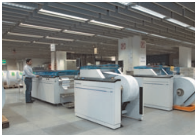
Die Offline-Linien für die Rolle-Stapel-Produktion erkennen die Codierungen der unterschiedlichen Kuvertiersysteme. Der Kunde gewinnt in der Verarbeitung ein hohes Mass an Flexibilität.
